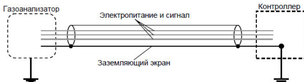
Рисунок 24 – Заземление экранированного кабеля
